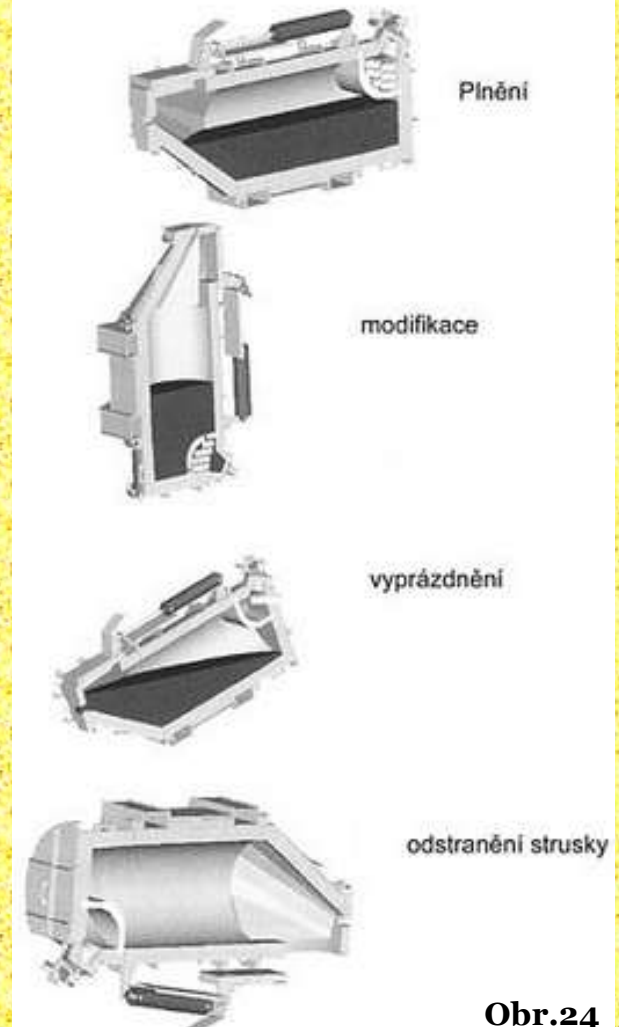
Pracovní polohy Fischerova konvertoru
